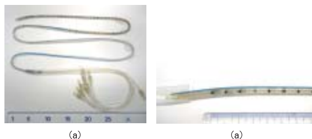
図6. (a) 食道内圧測定用チューブ：外径4.5mm，全長140cmのチューブである。 (b) 8チャンネルのチューブが一体となり，先端から3cmの部分から0, 1, 3, 5, 10, 15, 20cmの部分に直径2mmの側孔を有している。原則として，下部食道括約筋圧は0, 1, 3, 5cmの側孔で，食道体部圧は5, 10, 15, 20cmの側孔で測定する。
