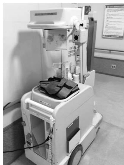
図 1-d 「ポータブル撮影装置」
