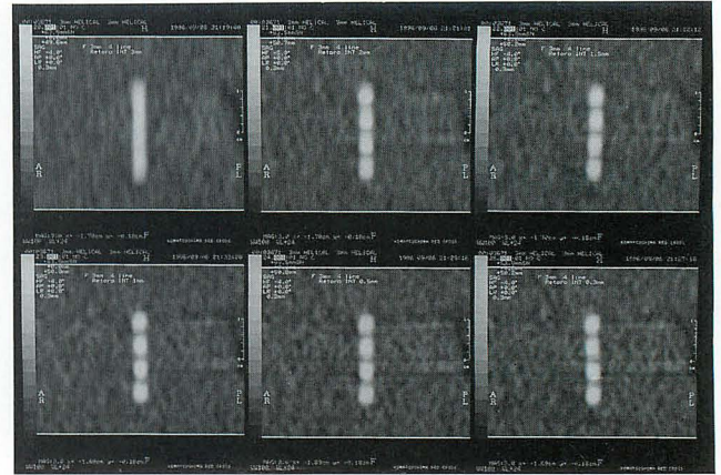
Fig.4-c スリット間隔 3 mm 4 line Recon-INT 3 mm 2 mm 1.5 mm (左上) (中上) (右上) 1 mm 0.5 mm 0.3 mm (左下) (中下) (右下)
