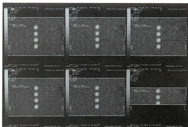
Fig.5-c スリット間隔 3 mm 4 line Recon-INT 1 mm 0.8mm 0.7mm (左上) (中上) (右上) 0.5mm 0.2mm 0.1mm (左下) (中下) (右下)
