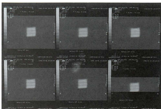
Fig.5-e スリット間隔 10 mm 2 line Recon-INT 1 mm 0.8mm 0.7mm (左上) (中上) (右上) 0.5mm 0.2mm 0.1mm (左下) (中下) (右下)
