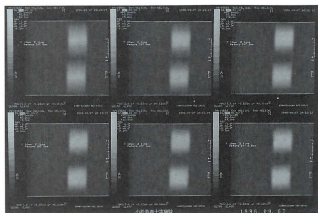
Fig.3-d スリット間隔 10 mm 2 line Recon-INT 5 mm 4 mm 3 mm (左上) (中上) (右上) 2 mm 1 mm 0.5mm (左下) (中下) (右下)
