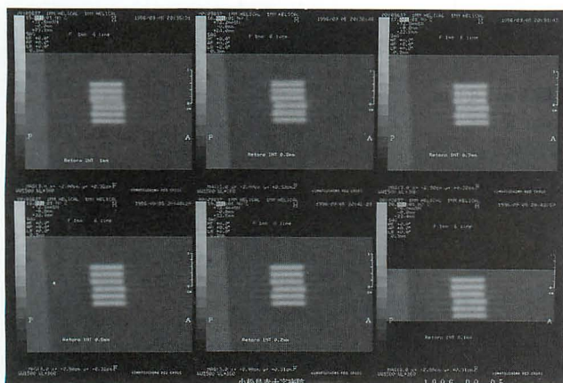
Fig.5-d スリット間隔 5 mm 3 line Recon-INT 1 mm 0.8mm 0.7mm (左上) (中上) (右上) 0.5mm 0.2mm 0.1mm (左下) (中下) (右下)
