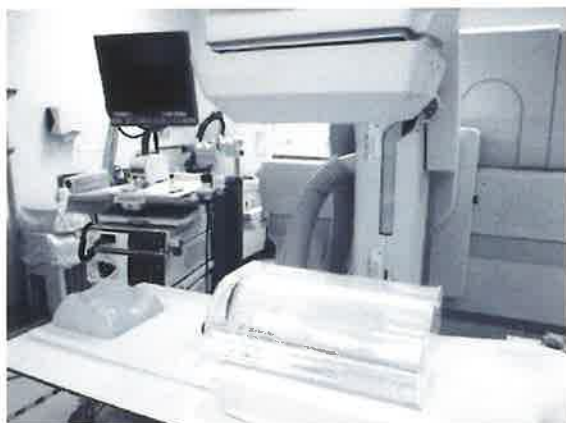
【図2】X線 TV 装置と散乱体水ファントム設置図
