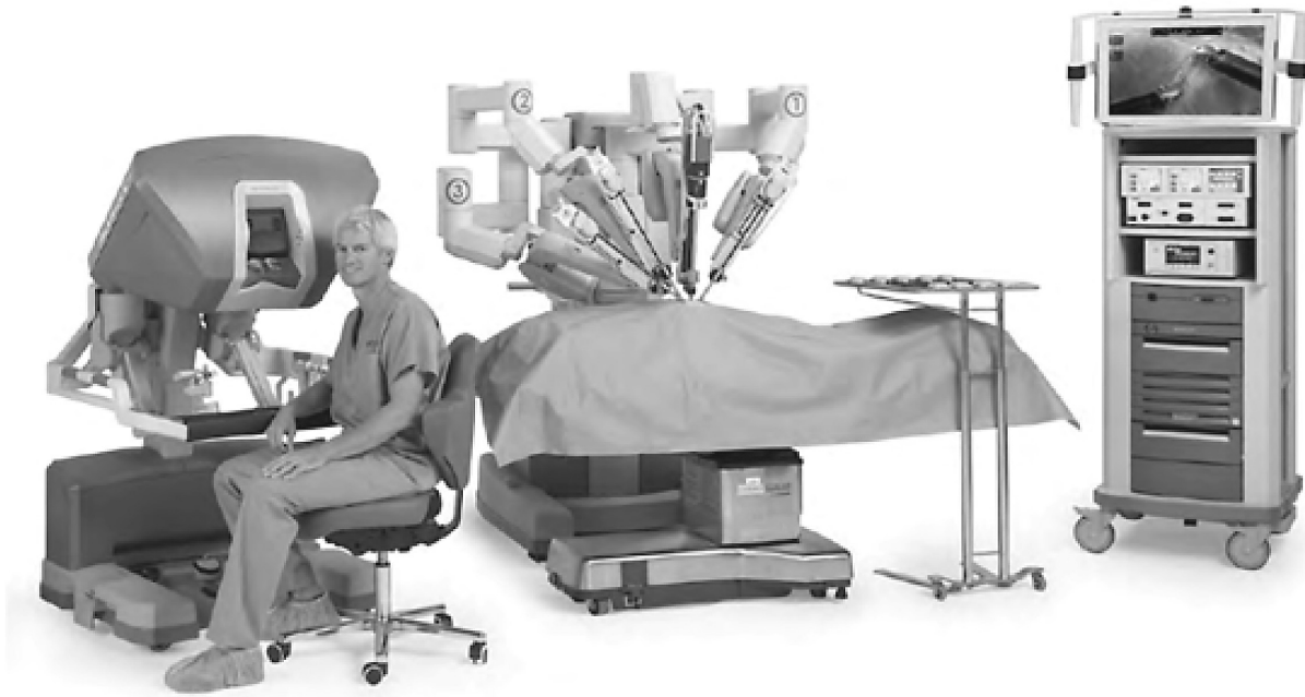
【図1】当院に導入されている da Vinci Si の構成
