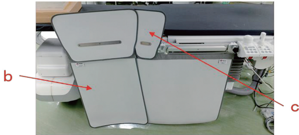
図2 鉛カーテン上の差し込み式鉛防護具
