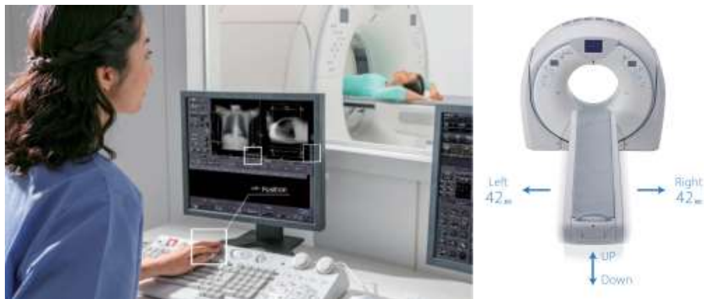
図 3. SUREPosition あらかじめ撮影した位置決め画像に従って、操作室側からボタンひとつで寝台の上下左右の位置を調整することが可能
