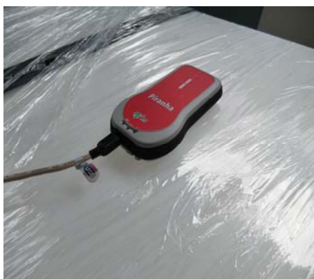
図 3 X線アナライザーを用いた出力測定と、作成した条件
